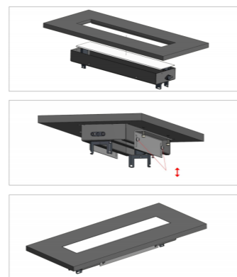
Primer vgradne vtičnice kot npr. Bachmann Top frame without frame
